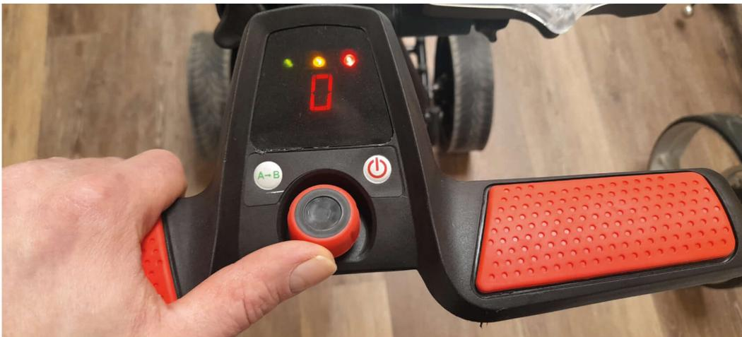
*Hinweis: Ihr Trolley ist mit einem Anfahrschutz ausgestattet um Unfälle beim Einschalten zu vermeiden. Sollte der Potentiometer beim Einschalten des Trolleys nicht vollständig zurück gedreht sein, so ist der Anfahrschutz aktiv. Bitte drehen Sie nun das Potentiometer gegen den Uhrzeigersinn ganz zurück um den Anfahrschutz zu deaktivieren. Anschließend können Sie Ihre Geschwindigkeit wie gewohnt einstellen.*
