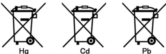
Cd = Batterie enthält mehr als 0,002 Masseprozent Cadmium
