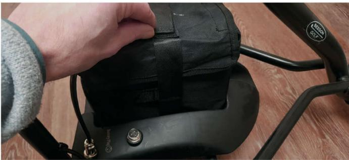
Verbinden Sie das Akkukabel mit dem Anschluss des Trolleys (3-polig). Dieser befindet sich in Fahrtrichtung rechts. Ein Verlängerungskabel zum Verstauen des Akkus im Bag (für Lithium-Akkus) ist optional erhältlich.
