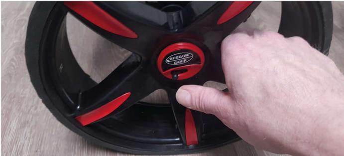
*Wichtiger Hinweis: Achten Sie unbedingt bei der Montage auf die Beschriftung der Räder (L und R in Fahrtrichtung). Wenn die Seiten vertauscht werden, dreht sich die Achse, aber der Trolley hat keinen Vortrieb.*
