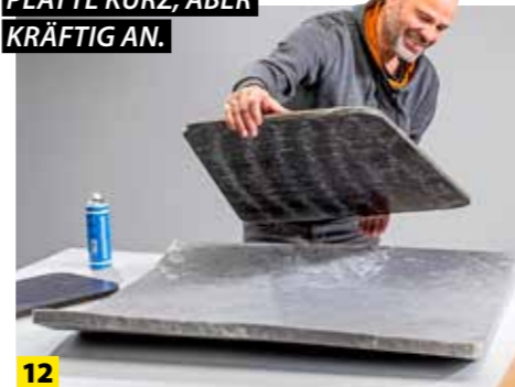
12 Legen Sie die Platte mit dieser Seite auf den grob vorgeschrittenen Schaumstoff.
