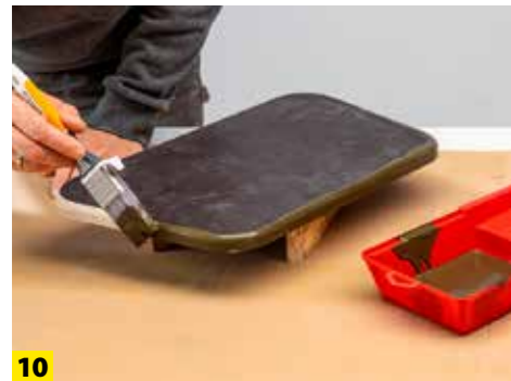
10 Anschließend haben wir die Kanten mit Acryllack versiegelt. Der Farbton ist dabei nebensächlich.
