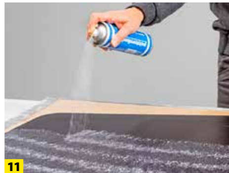
11 Tragen Sie nun gleichmäßig den Möbel-Sprühkleber auf die glatte, vordere Filmseite auf.
