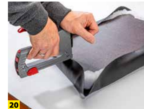
20 ... gepolsterte Platte darauf. Zunächst immer auf den gegenüberliegenden Seiten einmal mittig anheften. Leicht ziehen!
