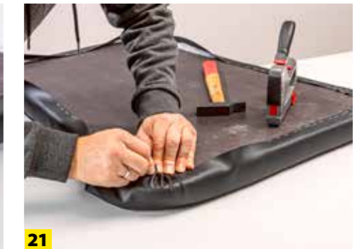
21 Dann in den Ecken das Kunstleder unter starkem Zug fächerförmig über die Kante ziehen. Es ist leicht dehnbar.
