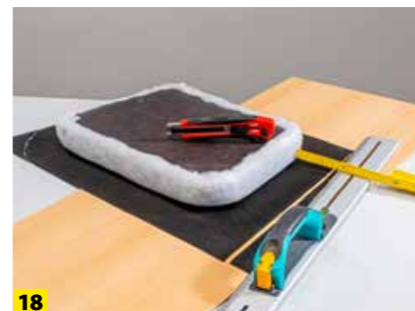
18 Schneiden Sie nun das Kunstleder zu. Rundum haben wir einen Überstand von 7 cm zum Plattenrand festgelegt.
