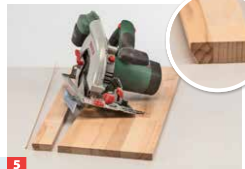
5 Jetzt die Sprossen zuschneiden. Zum Einhängen der Polster werden sie oben schräg hinterschnitten, die Spitze wird gekappt!
