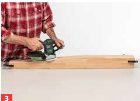
3 Wir haben alle vier Stützen miteinander verspannt und anschließend den Schrägschnitt mit dem Exzentrerschleifer geglättet.
