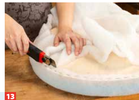
13 Das überschüssige Vlies kann mit einem Cuttermesser abgeschnitten werden.
