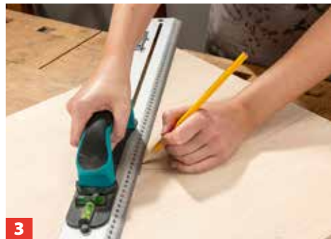
3 Schneiden Sie ein Brett in der Größe des Reifendurchmessers zu und markieren Sie den Mittelpunkt mit einem Kreuz.
