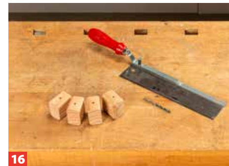
16 Damit das Polster nicht wegrutscht, werden mit einer Feinsäge vier Haltekötzchen zuge schnitten, durch die man ein Loch bohrt.
