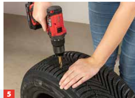
5 Um die Stichsäge wieder leichter zu positionieren, bohrt man erneut zuerst ein Loch in den Reifen.
