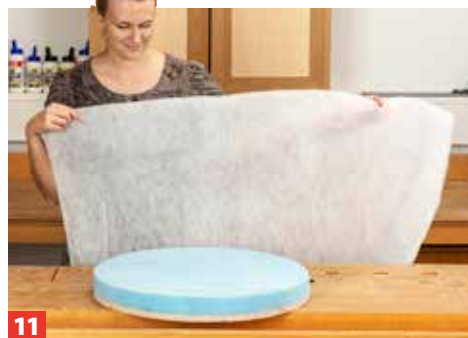
11 Nun wird das Ganze umgedreht und auf den Schaumstoff kommt wieder Sprühkleber. Darüber wird das Vlies gelegt und festgedrückt.
