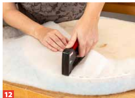
12 Das Vlies tackern Sie auf der Rückseite des Brettes fest. Wichtig ist, hierbei Falten zu vermeiden.
