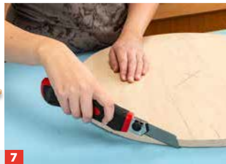
7 Legen Sie das kreisförmige Holzbrett auf den Schaumstoff und schneiden Sie ihn mit einem Cuttermesser aus.
