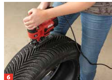
6 Anschließend wird mit der Stichsäge entlang der Linie der Henkel ausgeschnitten. Den Reifen dabei gut festhalten.
