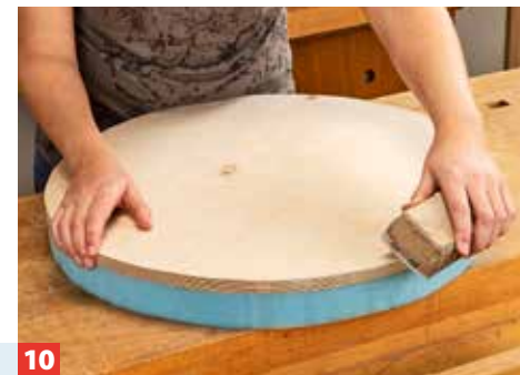
10 Um die Kante der Holzscheibe zu brechen, bearbeiten Sie sie mit dem Schleifklotz und Schleifpapier.
