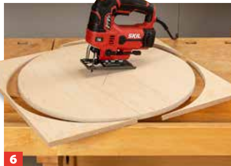
6 Der aufgezeichnete Kreis kann anschließend mit der Stichsäge ausgeschnitten werden.
