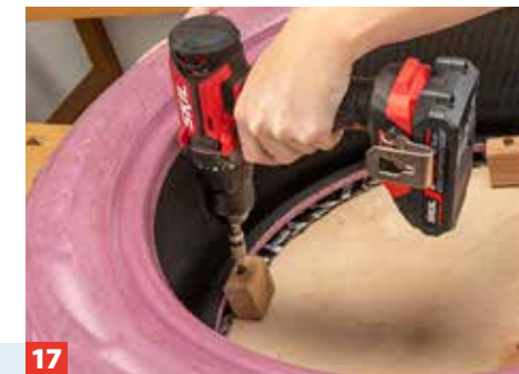
17 Zum Schluss drehen Sie die Unterseite des Polsters nach oben, legen den Reifen darauf und befestigen die Klötzchen am Rand.
