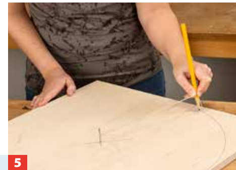
5 Um den Nagel einen Faden binden an dessen anderem Ende ein Stift befestigt wird. Damit lässt sich nun leicht ein Kreis ziehen.
