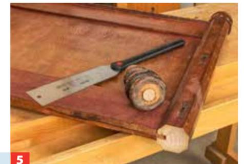
**5** Das Fußteil muss dementsprechend angepasst werden. Trennen Sie zunächst die Füße ab und kürzen danach das Fußelement.
