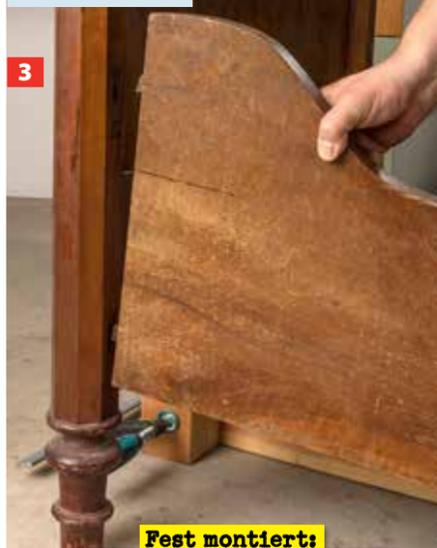
**Fest montiert:** Es ist egal, wenn die alten Beschläge nicht mehr gut halten, da die Bauteile später noch zusätzlich verschraubt werden.
