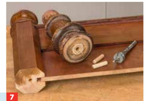
**7** ... erreicht werden. Dazu bei Füßen und Pfosten die Mittelpunkte anzeichnen und dort für 10er Dübel Sacklöcher bohren.
