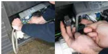
Stecken Sie das Hauptkabel durch die Kabelquetsche in das Powerpack. Ziehen Sie die Kabelquetsche fest und verbinden Sie das Kabel fest mit der Platine.
