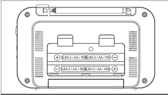
Abb. 4: Batterien einsetzen
