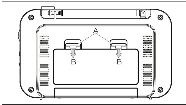
Abb. 3: Batteriefach öffnen
