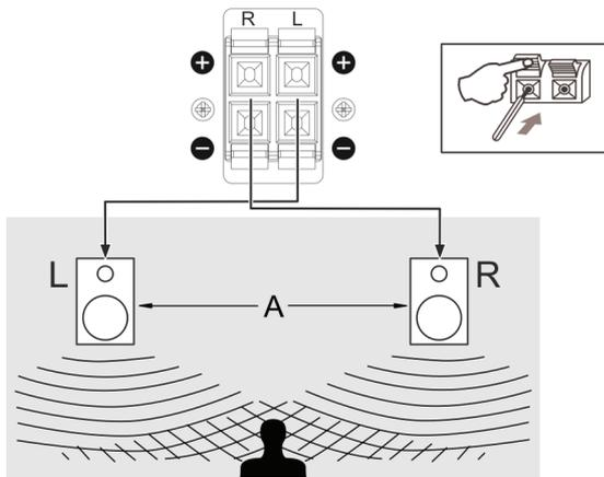
Die Lautsprecher mit dem mitgelieferten Lautsprecherkabel am Lautsprecheranschluss (22) anschließen.
