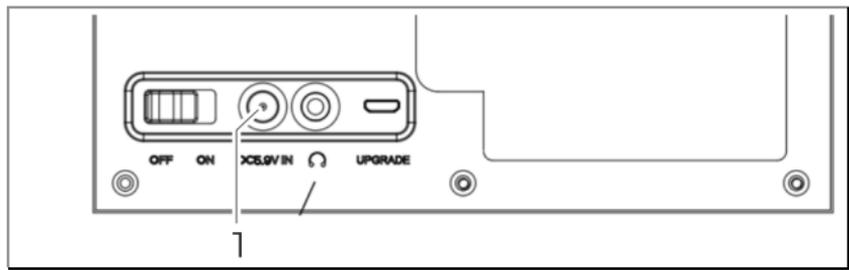
Abb. 2: Netzteil am Gerät anschließen
