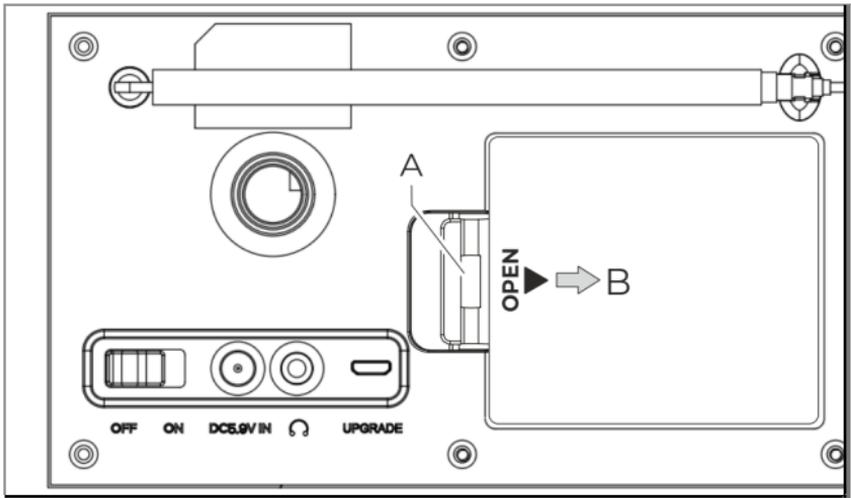
Abb. 3: Batteriefach öffnen
