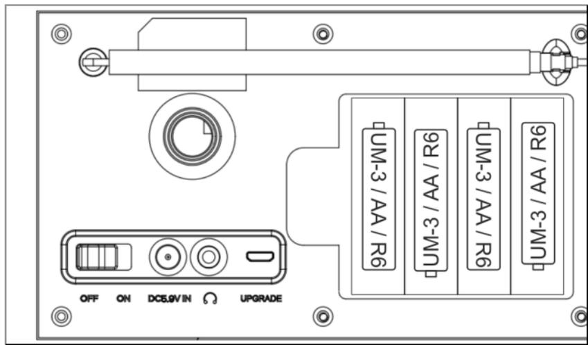
Abb. 4: Batterien einsetzen
