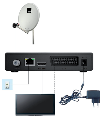
Beispiel 3 – System mit LAN-Verbindung
