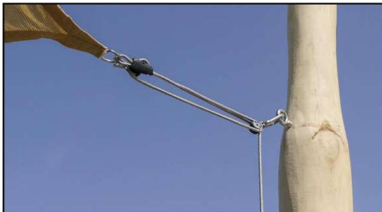
Mehr als dieses Set aus Sonnensegel-Holzpfosten und Befestigungsmaterial brauchen Sie nicht, um sowohl Befestigung als auch Höhenverstellung für eine Sonnensegel-Ecke zu realisieren. In diesem Sonnensegel-Pfosten werden drei Edelstahl-Ösen montiert, über welche eine bequeme Höhenverstellung erfolgen kann. Entspannen Sie dazu das Segel per Flaschenzug, so dass es abgenommen und in eine andere Öse erneut eingehängt werden kann.
