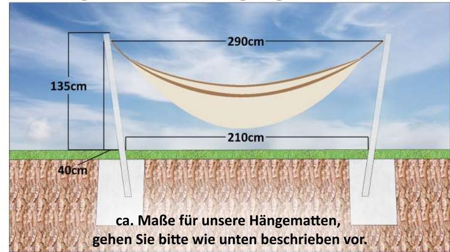
1. Erstellen Sie zwei Betonfundamente LxB 50x50cm und 80cm Tiefe. Diese Tiefe wird aufgrund der Frostschutztiefe benötigt.
