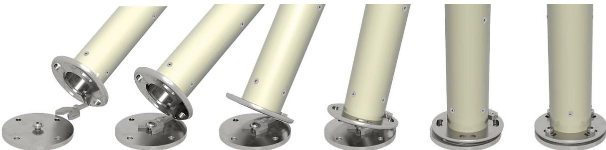
**1)** Schrauben Sie eine der 5 Flanschschrauben (M10x25) in das mittlere Loch, so dass sie noch 10mm übersteht. Bitte dieses Maß unbedingt einhalten.
