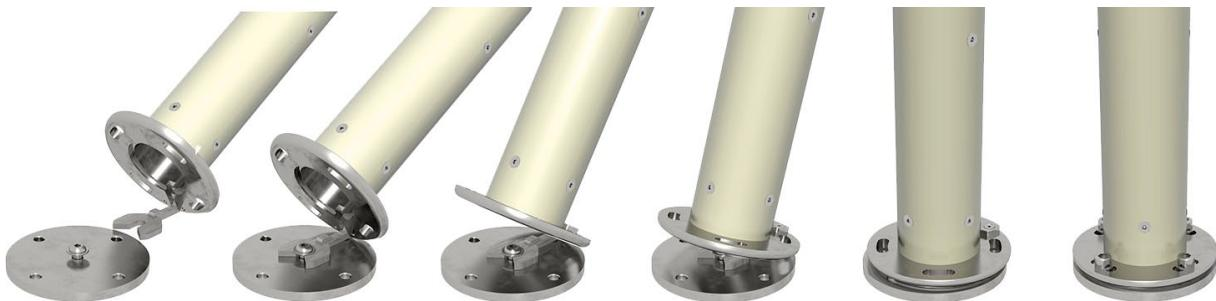
**1)** Vissez une des 5 vis (M10x25) dans le trou au milieu de manière à ce qu'elle dépasse de 10mm. L'indication de 10 mm doit être absolument respectée!
