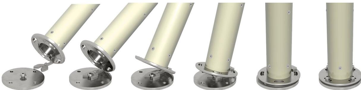
**1)** Insertar uno de los tornillos de brida (M10x25) en el hoyo del medio. Dejar el tornillo sobresalir de unos 10 mm.
