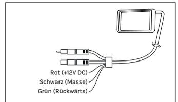
3. Das grüne Kabel mit dem +12V-Kabel des Rückfahrcheinwerfers verbinden (optional).
