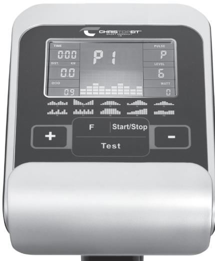
L'ordinateur de votre ERGOMÈTRE est très facile à utiliser. L'affichage simultané de toutes les fonctions vous permet de naviguer avec précision entre les fonctions individuelles. D'un coup d'oeil, vous êtes informé du déroulement de votre entraînement. Il s'agit ici d'un appareil indépendant du nombre de rotations. Pour sélectionner la puissance souhaitée, l'ordinateur règle le frein, indépendamment de la fréquence de marche à programme watts.
