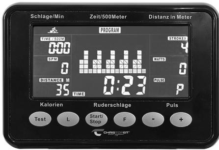
Sobald das Netzgerät angeschlossen wird ertönt ein Signal vom Computer und alle Anzeigensegmente vom Display leuchten für 2 Sekunden auf.
