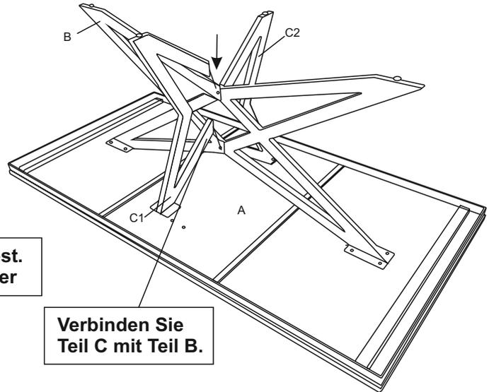
Ziehen Sie die Inbusschrauben nicht vollständig fest. Lassen Sie sie für den nächsten Schritt etwas locker
