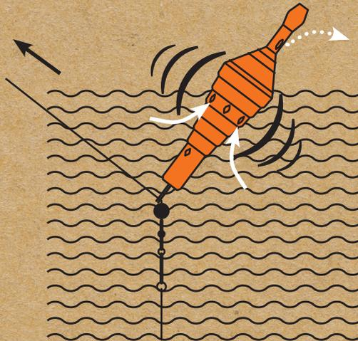
Durch kurzes Anzupfen an der Angelschnur stellt sich der Clever Float schräg. Über die Einlauföffnungen läuft Wasser nach und Luft entweicht durch die oberen Öffnungen am Hals.
