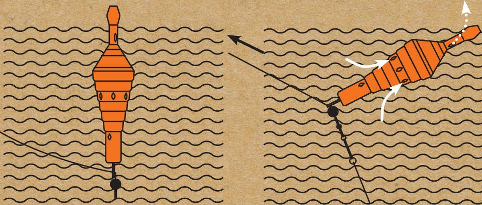
Die Clever Floats schwimmen nicht im Wasser - die Clever Floats schweben mittels komprimierter Luft. Durch das Nachstellen (wie auf der vorigen Seite beschrieben) gelangt mehr Wasser ins Innere und weitere Luft kann entweichen.
