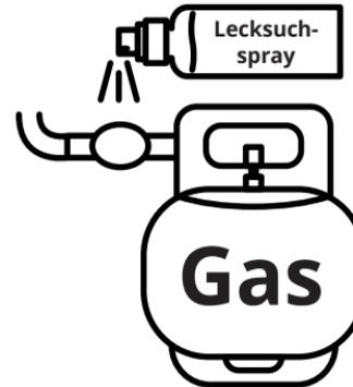
Vor der Inbetriebnahme alle Schraubverbindungen der Gasleitungen auf Dichtigkeit prüfen.
