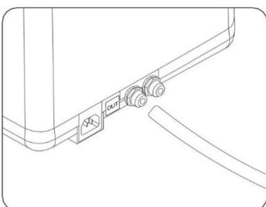
Stecken Sie ein Ende des Abwasserschlauchs in den mit „OUT“ markierten Anschluss auf der Rückseite des Geräts und verbinden Sie das andere Ende mit der Abwasserleitung.
