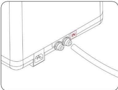
Stecken Sie das andere Ende des Wassereinlassschlauchs durch das gebohrte Loch in den mit „IN“ markierten Anschluss auf der Rückseite des Geräts.
