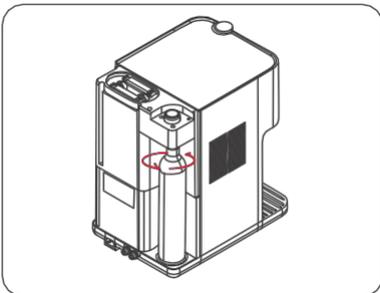
3. Schrauben Sie die Patrone gegen den Uhrzeigersinn in das Gewinde.
