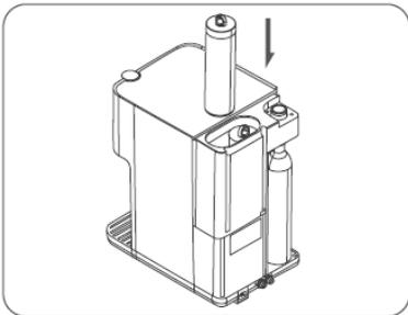
5. Installieren Sie die neuen Filterelemente.
