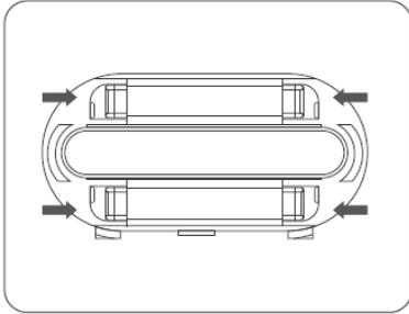
3. Drücken Sie die Halteklammer für das Filterelement mit beiden Händen zusammen und nehmen Sie die Klammer heraus.
