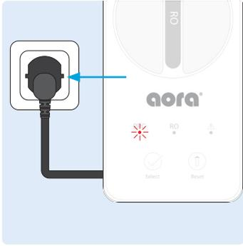
**1.** Das Netzkabel ziehen bevor man mit dem Filterwechsel beginnt.
