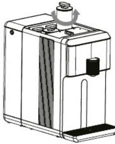
**2.** Das alte Filterelement gegen den Uhrzeigersinn drehen und nach oben rausziehen.
