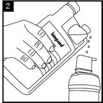
Geben Sie 25 ml „Bioguard Internal“ Reinigungsmittel in eine saubere und leere „Service-Filter“-Kartusche und befestigen diese im Wasserspender.
