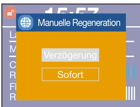
Durch drücken der 'SET/REGEN' Taste kann der Benutzer die Art der Regeneration einstellen und mit der 'MENÜ' Taste die Regeneration auslösen.
