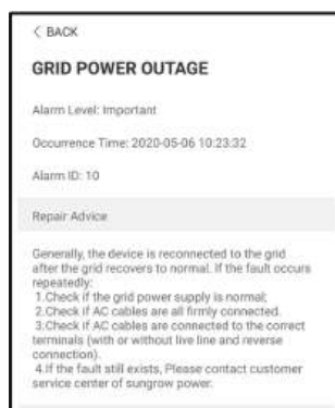
figure 7-9 Detaillierte Informationen einer Störungsmeldung
