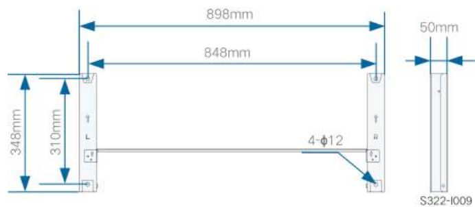
figure 4-1 Abmessungen des Befestigungswinkels
