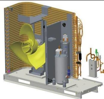
Entfernen Sie den Kompressor und den Gas-Flüssigkeitsabscheider.
