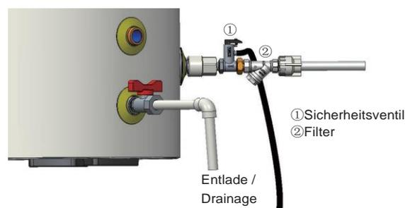
Installationsmodus des Leitungswasserentlastungsventils 1 (Wassereinlassdruck = 0,1 bis 0,5 MPa)
