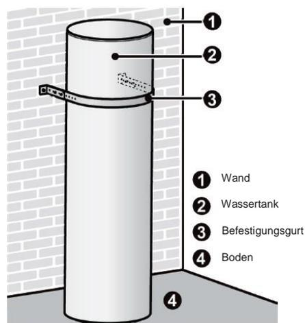
Der Mindestabstand zwischen dem Wassertank und der brennbaren Oberfläche sollte 500 mm betragen.
