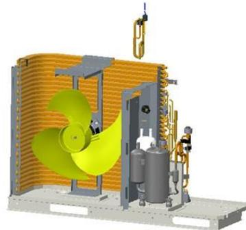
Entfernen Sie die Economizer-Befestigungspunkte, entfernen Sie die Befestigungsschrauben und entfernen Sie dann den Economizer.
