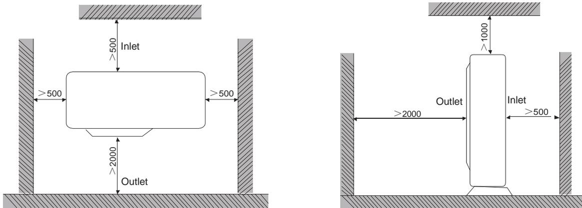
Hinweis: Bei der Sicherstellung der Platzbeschränkung muss darauf geachtet werden, dass für die linkshändige Figur der Abstand zwischen dem Gerät und dem nächsten Hindernis auf den anderen drei Seiten, mit Ausnahme der Ausgangsseite, nicht weniger als 300 mm beträgt; Bei einem Rechtshänder muss darauf geachtet werden, dass der Abstand zwischen der Einstiegsseite und dem nächsten Hindernis nicht weniger als 300 mm beträgt.
