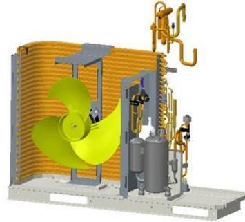
Schrauben Sie die Verbindungsstellen der Saugleitungen ab und entfernen Sie die Saugleitungen.
