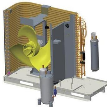
Entfernen Sie die Lüfterbefestigungsschrauben und -mutter.
