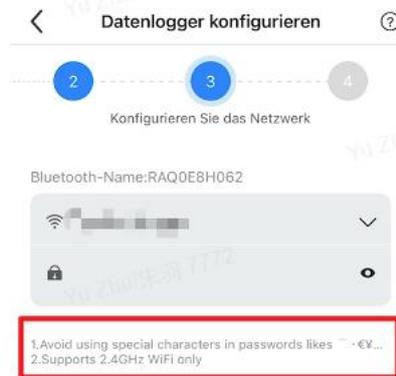
2. Nach der erfolgreichen Datenloggerkonfiguration des ShineWeLink wird der Verbindungsbildschirm zum Hinzufügen des Wechselrichters angezeigt. Bei erfolgreicher Konfiguration wird eine Meldung angezeigt und automatisch zum **“Gerät hinzufügen”** gewechselt.
