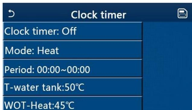
3. Option „Modus“, Modus wird verwendet, um die Zeit des gewünschten Modus einzustellen; „WOT-Heizung“ mit **WOT-Heat** und „T-Wassertank“ wird die entsprechende Wassertemperatur eingestellt; „Period - Period“ wird für die Zeiteinstellung verwendet. Danach werden alle Einstellungen mit der Schaltfläche „Speichern“ gespeichert.
