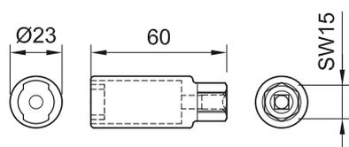
Steckschlüssel zum Kontern (PV-SSE-AD4)
