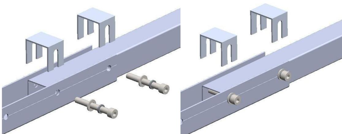
Step 4: Ziehen Sie die Schrauben fest, um die Installation abzuschließen.
