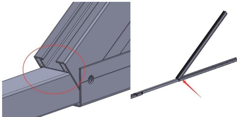
Step 3: Fügen Sie eine 30 mm lange Öffnungshülse hinzu und führen Sie diese in den Spalt zwischen dem Anschluss und dem Stativ ein.
