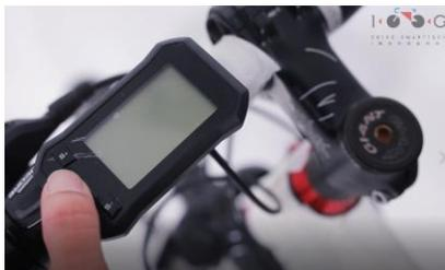
Montieren Sie das Display an den Lenker
