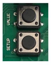
Der Zugri auf das Konfigurationsmenü ist durch langes Drücken der SETUP- Taste (Pos 3) bei null Krediten oder durch das Halten beider Tasten, während man das ausgeschaltete Gerät mit dem Ein-/Aus-Schalter auf der Rückseite des Geräts einschaltet. Der Zugri auf das Konfigurationsmenü wird durch einen "Gong" bestätigt, die Taste(n) können nun losgelassen werden.
