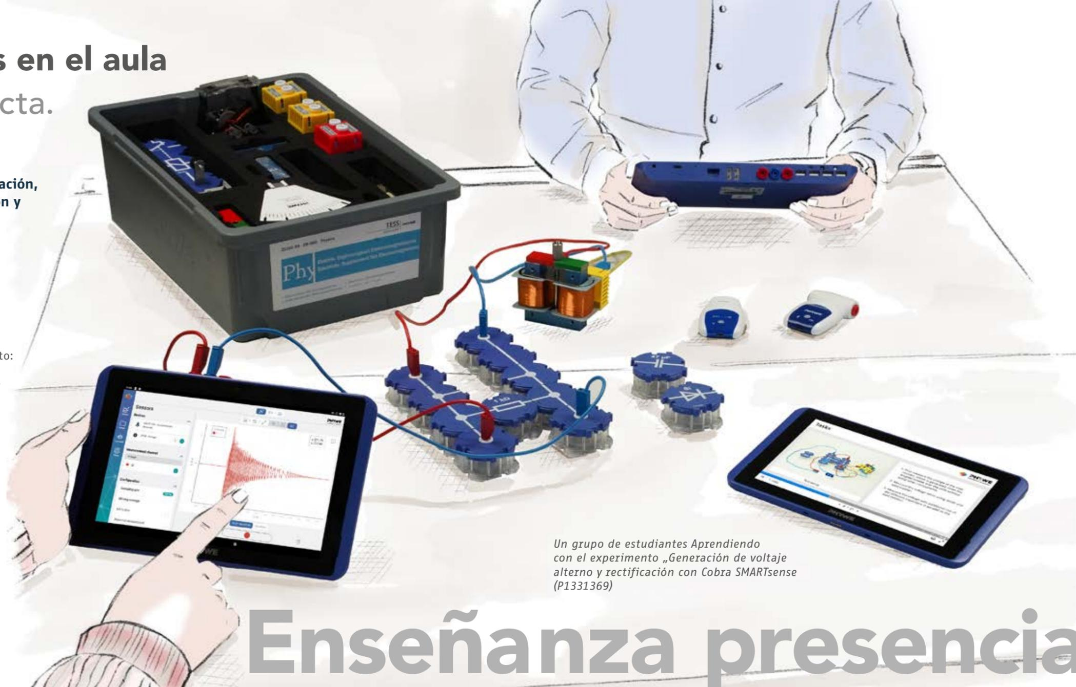
Un grupo de estudiantes Aprendiendo con el experimento „Generación de voltaje alterno y rectificación con Cobra SMARTsense (P1331369)
