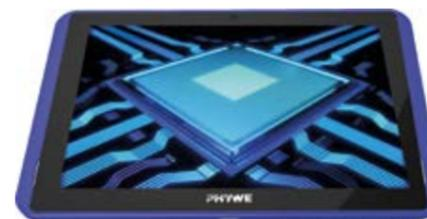
Ein leistungsfähiger 8-Kern-Prozessor mit 2 GHz Taktung, 4 GB Arbeitsspeicher und eine 64 GB SSD Festplatte stellen sicher, dass immer alles flüssig läuft.
