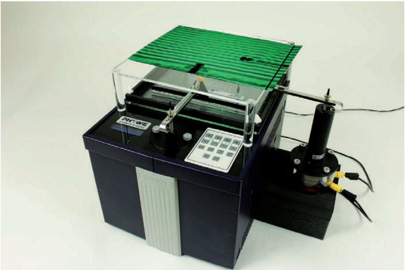
PHYWE Wasserwellengerät mit externem Vibrationsgenerator
