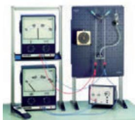
Leitet man elektrischen Strom durch eine Lösung, so kann es dabei zu Stoffumwandlungen kommen. Der Strom ist dabei die treibende Kraft der ablaufenden Redoxreaktionen. Elektrolysiert man Wasser, das durch den Zusatz von Ionen leitend gemacht wurde, erhält man an der Kathode Wasserstoff und an der Anode Sauerstoff. Fängt man diese beiden Gase getrennt auf, wie etwa mit einem Wasserersetzer nach Hofmann, kann man die Reaktion quantitativ verfolgen und so die beiden Faradayschen Gesetze ableiten.
