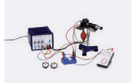
Geladene Öltröpfchen, die zwischen den Platten eines Kondensators einem elektrischen Feld und der Erdbeschleunigung unterworfen sind, werden durch Anlegen einer Spannung beschleunigt. Aus den Geschwindigkeiten in Richtung der Erdbeschleunigung und entgegengesetzt dazu wird die Elementarladung bestimmt.
