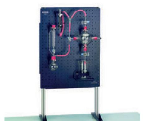
Einige Gase wie Chlorwasserstoff lösen sich sehr gut in Wasser. So löst 1 Liter Wasser bei 20°C ca. 443 Liter Chlorwasserstoff. In einem geschlossenen Kolben bildet sich bei Kontakt des Gases mit etwas Wasser rasch ein Unterdruck, da sich das Gas im Wasser löst und weiteres Wasser in den Kolben gesaugt wird.
