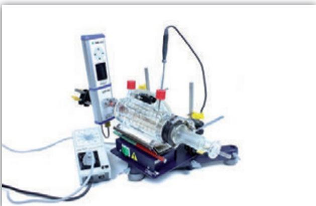
Zustandsgleichung idealer Gase mit Cobra4 (Gasgesetze: Gay-Lussac, Amontons, Boyle) (P2320162)
