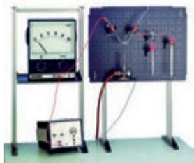
Die Schmelzflusselektrolyse von Natriumchlorid zur Gewinnung von Chlor und Natrium, das zu Natronlauge weiterverarbeitet wird, ist ein wichtiges großtechnisches Verfahren.
