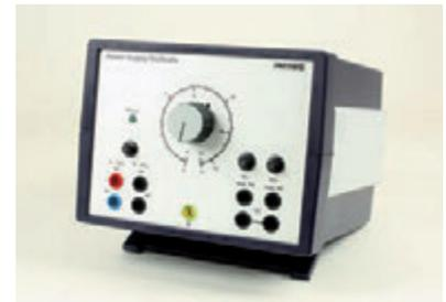
Netzgerät mit 5 Ausgangsspannungen, speziell geeignet für Röhrenversuche, Fadenstrahlrohr
