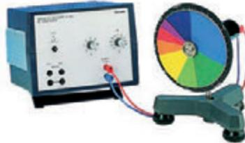
Wird eine in farbige Sektoren aufgeteilte Kreisscheibe von einem Motor so rasch gedreht, dass das Auge die einzelnen Farben nicht mehr auflösen kann, so entsteht die Empfindung einer Mischfarbe. Durch Variieren der Zusammensetzung und Größe der Sektoren kann jeder beliebige Farbeindruck erzeugt werden. Mit Hilfe des Farbendreiecks lässt sich vorherhersagen, welcher Farbeindruck jeweils entsteht.
