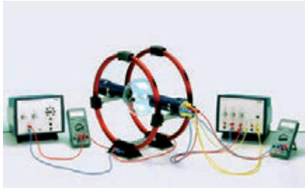
Elektronen werden im elektrischen Feld im Fadenstrahlrohr beschleunigt und treten in ein zur Flugrichtung senkrechtes homogenes magnetisches Feld eines Helmholtz-Spulenpaares ein. Aus der Beschleunigungsspannung, der magnetischen Feldstärke und dem Bahnradius der Elektronen wird die spezifische Ladung des Elektrons bestimmt.
