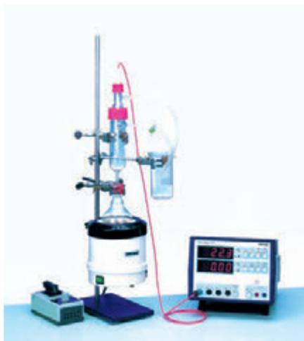
Der Siedepunkt einer Lösung ist stets höher als der des reinen Lösungsmittels. Die Abhängigkeit dieser Temperaturdifferenz (Siedepunktserhöhung) von der Konzentration des gelösten Stoffes wird mit einer geeigneten Apparatur bestimmt.
