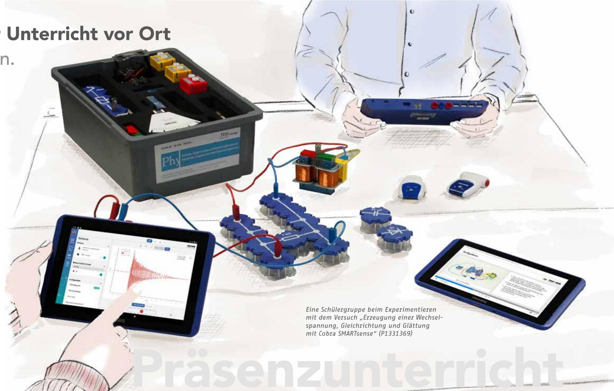
*Eine Schülergruppe beim Experimentieren mit dem Versuch „Erzeugung einer Wechselspannung, Gleichrichtung und Glättung mit Cobra SMARTsense“ (P1331369)*
