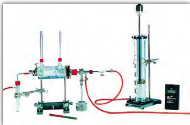
Kalorimetrie (z. B. Heizwert von Kohle, P3021601)
