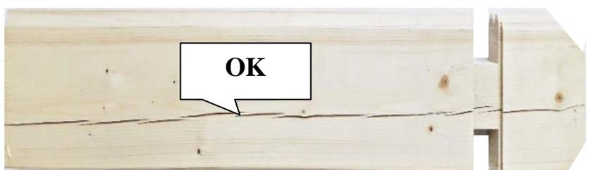
Nicht vollständig gehobelte Oberfläche: zulässig sind kleine Rauheit rund um die Äste, kaum bemerkbare Welligkeit auf der Oberfläche, kleine mechanischen Beschädigungen bis zu 20 mm der Kantenbreite und kleine mechanischen Beschädigungen an Enden, welche die Breite des Brettes nicht überschreiten. Zulässig sind außerdem nicht vollständig gehobelte Seitenflächen, wenn dadurch das Gesamtbild von zwei zusammengesetzten Brettern nicht beeinträchtigt wird.
