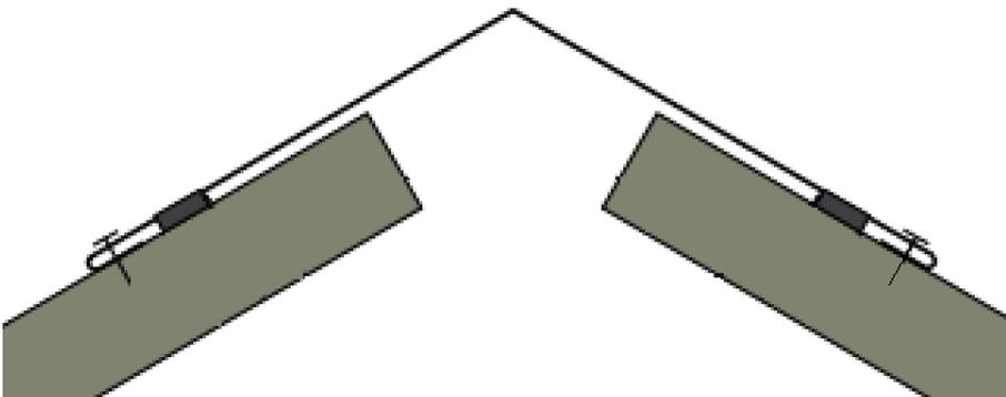
4. Befestigen Sie dann im Anschluss die Ortgangsbleche an den Stirnseiten Ihres Gartenhauses entsprechend der untenstehenden Zeichnung. Nutzen Sie dafür die 35mm Schrauben.
