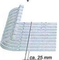
Methode zur Bestimmung des geeigneten Gefälles - die weiße Linie kennzeichnet die Stelle, an der der Haken gebogen werden muss.
