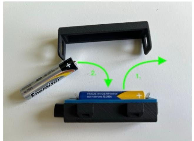
Abschließend kann der Deckel wieder auf der Box angebracht werden. Hierbei ist zu beachten, dass die beiden Öffnungen des Deckels unterschiedliche Größen und Formen haben. Die größere Öffnung wird zunächst über die Steckerbuchse geschoben, bevor die kleinere Seite formschlüssig am hinteren Ende der Box abschließt.
