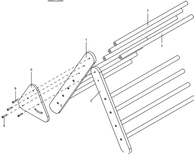
Stecken Sie den Holzstab 2 (Nr. 7 - 4St.) in das Loch des Bretts 1 (Nr. 1) und des Bretts 2 (Nr. 2) und befestigen Sie sie mit der Innensechskantschraube M8X40 (Nr. 9 - 4St.) und dem Verbindungsbrett (Nr.5).
