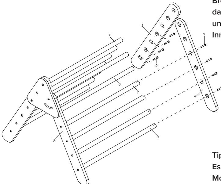
Stecken Sie den Holzstab 1 (Nr. 6) in das Loch des Bretts 2 (Nr. 2), den Holzstab Nr. 2 (Nr. 7 - 8 St.) in das Loch des Bretts 3 (Nr. 3) und des Bretts 4 (Nr. 4) und befestigen Sie sie mit der Innensechskantschraube M8X40 (Nr. 9 - 8 St.).
