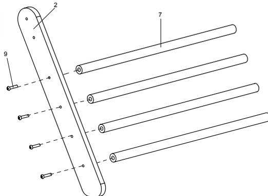
Stecken Sie den Holzstab 2 (Nr. 7 - 4Stk.) in das Loch des Bretts 2 (Nr. 2) und befestigen Sie ihn mit der Innensechskantschraube M8X40 (Nr. 9 - 4Stk.).
