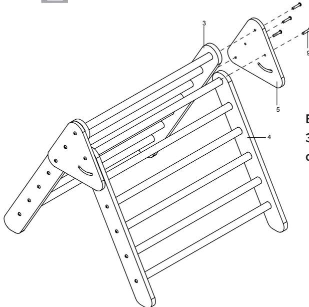
Befestigen Sie das Verbindungsbrett (Nr. 5) am Brett 3 (Nr. 3) und am Brett 4 (Nr. 4) und sichern Sie sie mit der Innensechskantschraube M8X40 (Nr. 9 - 4St.).
