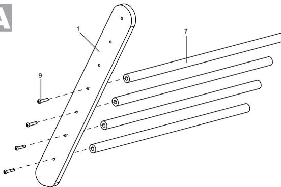
Stecken Sie den Holzstab 2 (Nr. 7 - 4Stk.) in das Loch des Bretts 1 (Nr. 1) und befestigen Sie ihn mit der Innensechskantschraube M8X40 (Nr. 9 - 4Stk.).
