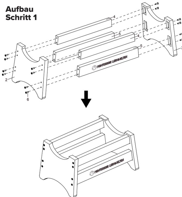
Befestigen Sie die vorderen oberen Bretter (Nr.4) und die vorderen unteren Bretter (Nr.5) zwischen dem linken (Nr.2) und der rechten (Nr.3) Seitenbrett mit Kreuzsenkkopfschrauben (Nr.7-16).
