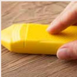
Die flache Seite des Schmelzers auf die Befüllung legen und durch leichtes Reiben mit den Rillen den Überstand abscheren. Bei eventuellen Fehlstellen den Füllvorgang wiederholen und danach Überstände abtragen.
