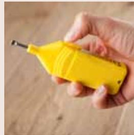
Verschlusskappe des gelben Schmelzers entfernen. Runden Knopf entriegeln und nach unten drücken. Schmelzer wird so aktiviert und Spitze heizt sich auf. Loslassen des Knopfes lässt Spitze erkalten. Wechsel von Drücken und Loslassen reguliert die Temperatur.
