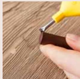
Maserungen und Holzstrukturen können ganz einfach erzeugt werden und tragen zum perfekten Erscheinungsbild bei. Dazu passenden Füllstoff wählen.
