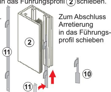
Zum Abschluss Arretierung in das Führungsprofil schieben
