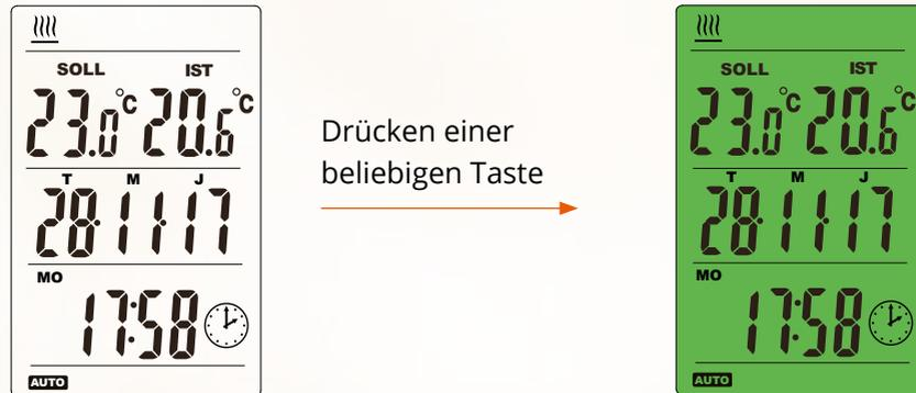
Um eine Einstellung zu ändern, muss das Display eingeschaltet sein (1× Drücken einer beliebigen Taste). Das Display schaltet nach 15 Sekunden selbstständig wieder aus. Wenn Sie eine Einstellung programmieren, schaltet der Thermostat nach 30 Sekunden ohne Eingabe zurück in das Hauptmenü! Bereits gemachte Eingaben werden dabei automatisch gespeichert. Sie sollten daher die Programmierung zügig durchführen!
