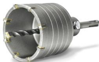
214.008.082-Scie hélicoïdale S&R 82 mm Ø 82 mm avec adaptateur SDS plus 110 mm et fraise centrale 8x110 mm.
