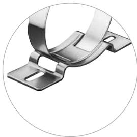
Die **NORMACLAMP®** HMK K1 sind vorgefertigte Konsolen, mit denen Sie **NORMACLAMP®** Standardschellen (Typen GBS, HD, SP und TORRO) im Handumdrehen in Halierungsschellen mit Konsole umwandeln können. Öffnen Sie einfach die Standardschelle und führen Sie das Band durch den Konsolenschlitz, fertig.
