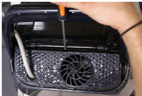
7.1. Das Schutzgitter entfernen Sie mit einem flachen Schlitzraubendreher.
